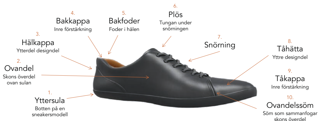
Figur 4. Översikt av en sneakers olika delar. Bild baserad på Vesin (2024), omarbetad av författarna utifrån input från projektets deltagare och referensgrupp.
